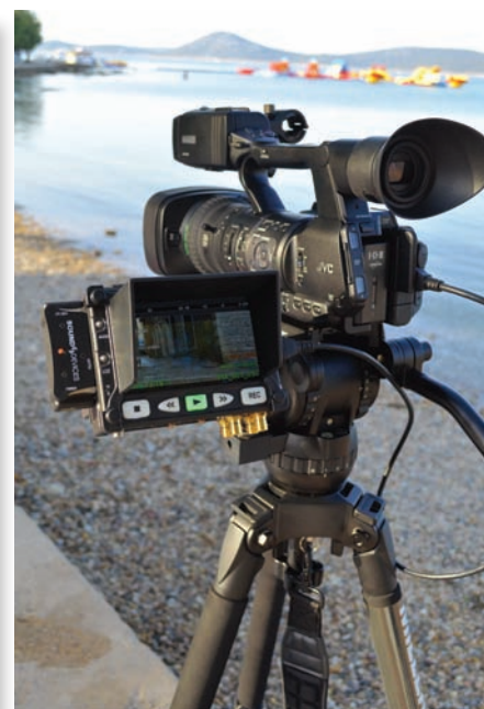
Вариант крепления рекордера на штатив с помощью сочлененной руки
