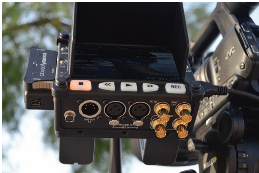
Вид на основные сигнальные интерфейсы и клавиши управления режимами
