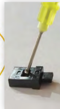
Рис. 4. Заливка клея в ферулу
