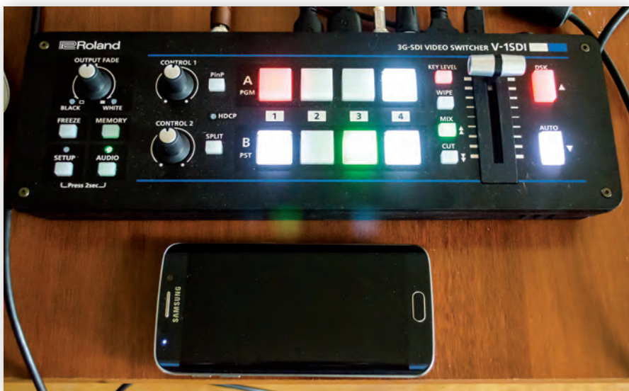
Миниатюрный микшер V-1SDI. Оценить его размеры несложно, сравнив со смартфоном
