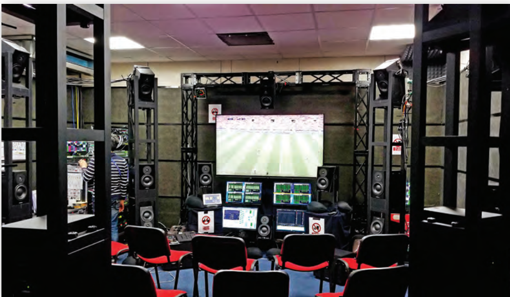
8K-театр, развернутый корпорацией NHK в Международном вещательном центре в Москве. Здесь вещатели могли оценить качество 8K-изображения и звука 22.2
