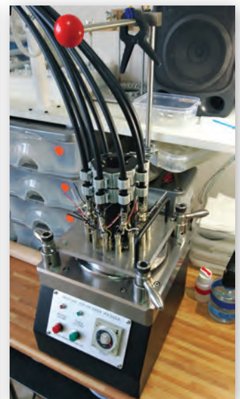
Полировка оптических феррулов F2 в лаборатории Om Network при помощи нового блока SEIKOH GIKEN
