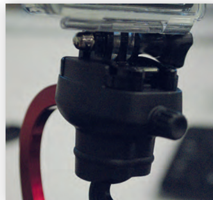
Головка стабилизатора с регулятором баланса в продольном направлении
